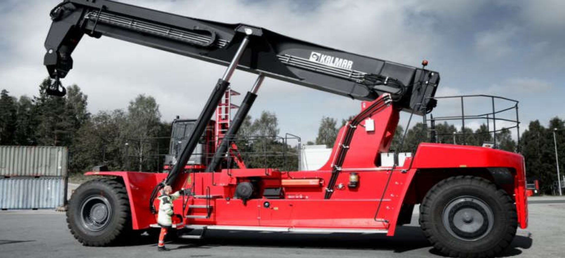
KALMAR DRG1000-92 ZXS, viljuškar najveće nosivosti Nazivna nosivost 100 tona!
